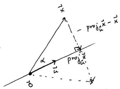
$\text{refl}_{\vec{u}} \vec{x} = \vec{x} + 2(\text{proj}_{\vec{u}} \vec{x} - \vec{x})$
