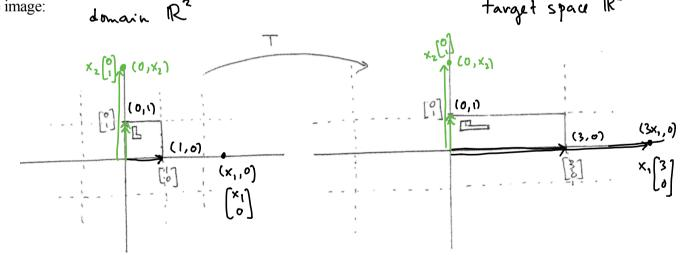
$$A = \begin{bmatrix} 3 & 0 \\ 0 & 1 \end{bmatrix} \begin{bmatrix} 1 \\ 0 \end{bmatrix} = \begin{bmatrix} 3 \\ 0 \end{bmatrix}$$
